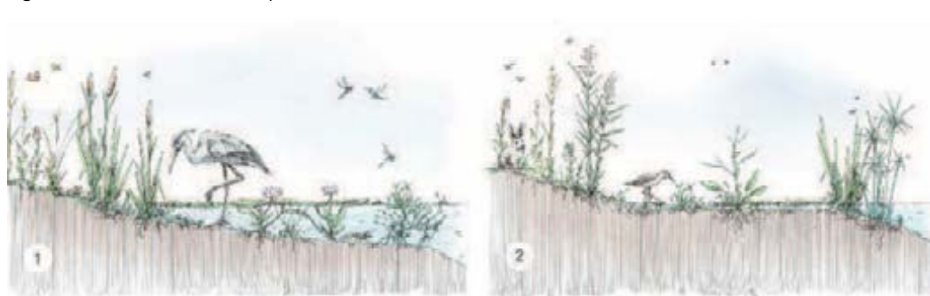
Figuur 44: Doorsnede van een plasberm en een drasberm. Bron: Van Breukelen et al, 2003
